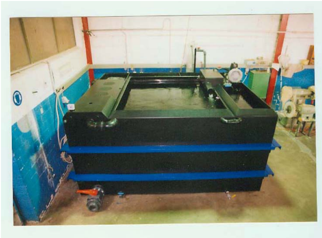
Platzraubende horizontale Verfahrenstechnik ohne Strömung 1. Phase 1995
