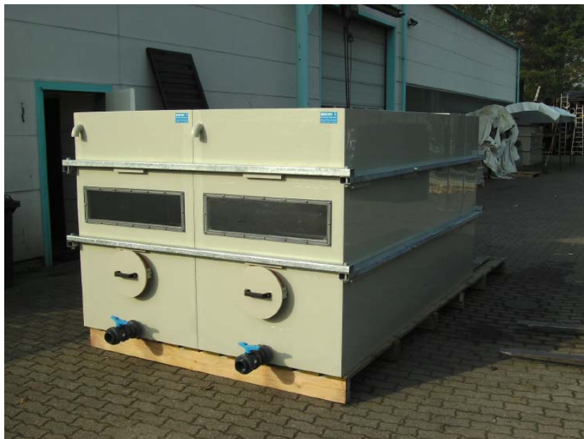
Besseres Design aber immer noch nicht okay (Stahlkorsett, Fischschleuse, Schlammablass, Sichtfenster usw.) 4. Phase 2005
