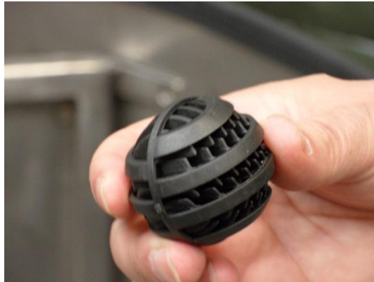
Herz der biologischen Aufbereitung: Füllkörper
