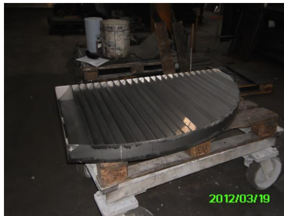
Bild 4: Edelstahl-Schräglärelement ohne Trenngitter
