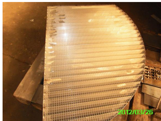
Bild 5: Edelstahl-Schräglärelement mit Trenngitter
