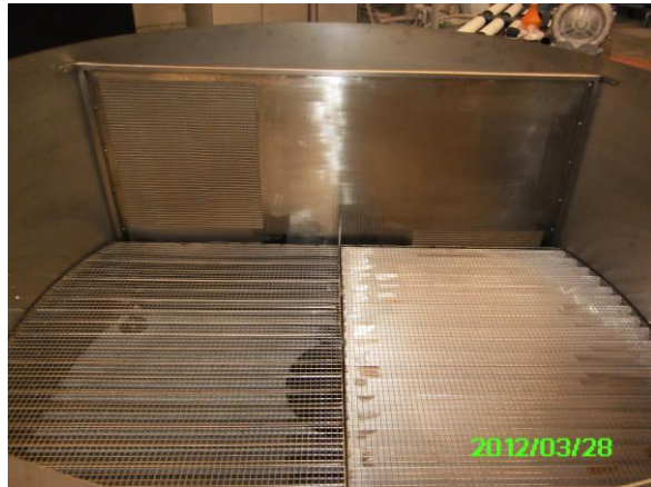
Bild 6: Edelstahl-Schrägklärer an Strömungsrichtung angepasst
