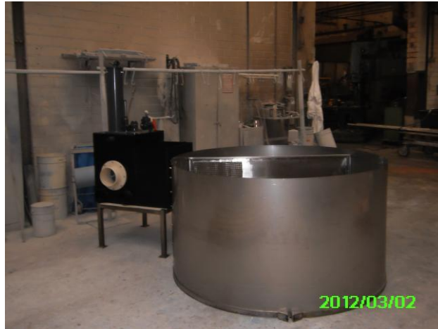
Bild 1: IRAS provisorisch verschraubt mit Trennwand und mechanischer Bypass-Reinigung
