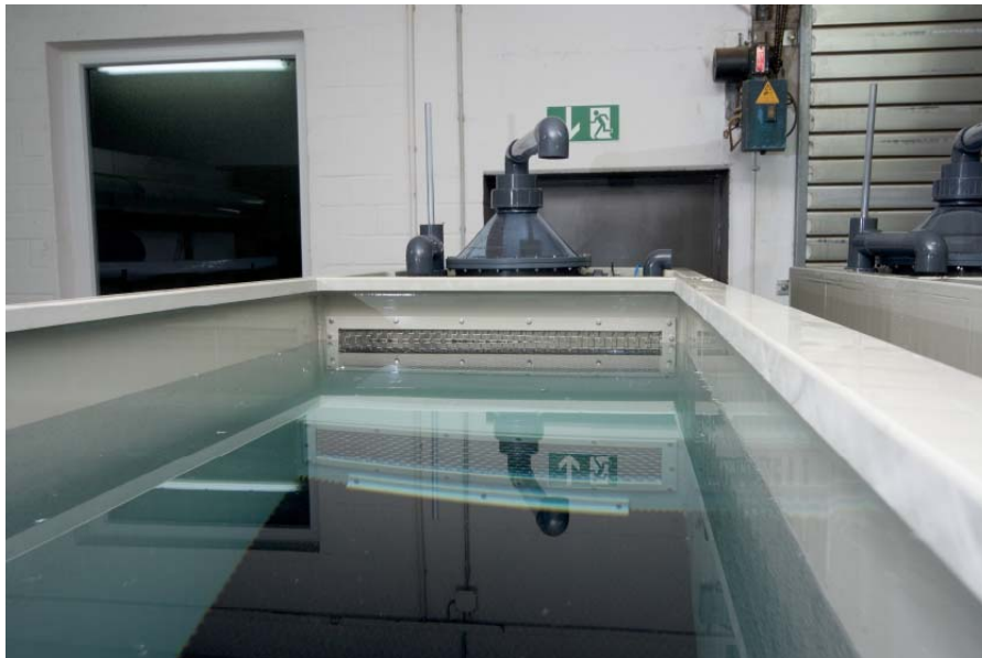
IRAS Twin versandfertig Das linke Becken ist voll mit Wasser. Optimale Statik dank Hohlkammerplatten
